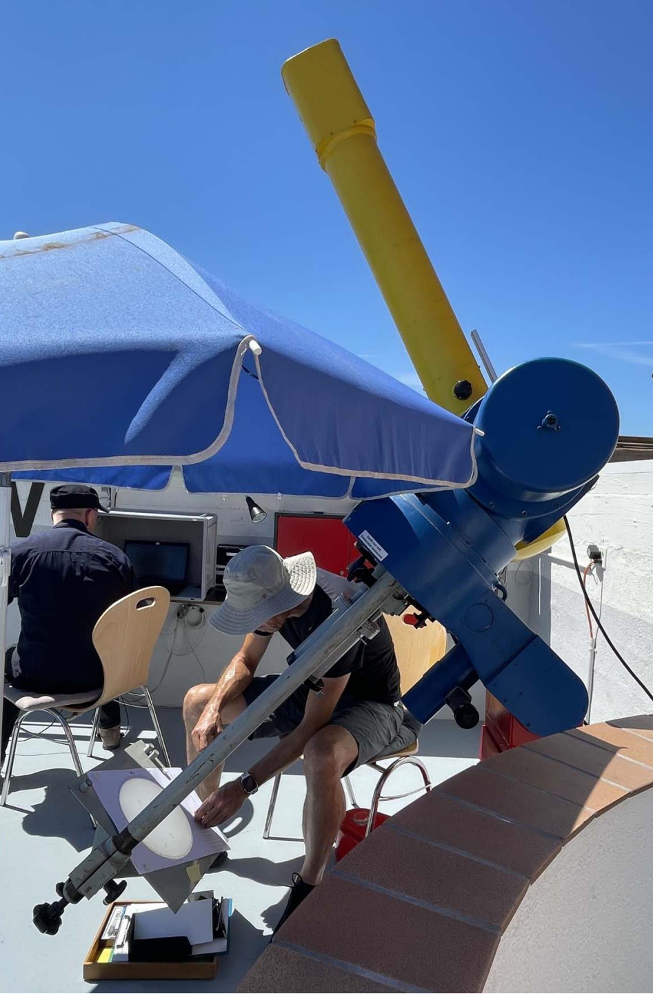
Okularprojektion auf die Zeichnungsfläche
