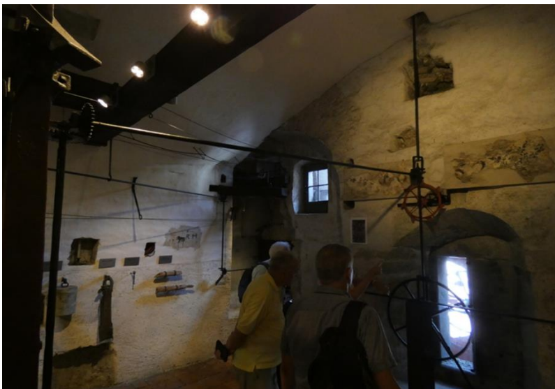
Die Gestänge und Drähte, welche die Bewegung vom Uhrwerk auf die Zeiger und Figuren übertragen.
